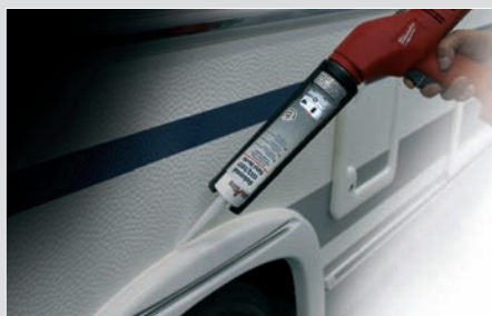
Abdichten von Seitenverkleidungsverbindungen
