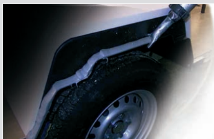
Abdichtung zwischen Seitenverkleidung und Radkästen
